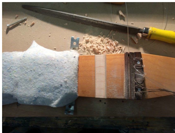
Фиг. 5 — Издълбаният канал с дълбочина около 5 мм., в който да бъде поставен адаптера
