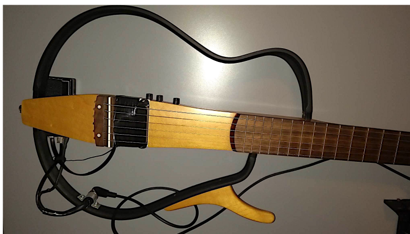
Фиг. 8 — Yamaha SLG130NW с монтиран хексафониичен адаптер, хексафониичен предусилвател и необходимото окабеляване
