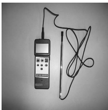
Figura 10.3 – Anemômetro de fio quente
