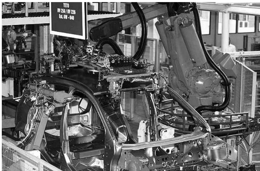
Figura 6.3 – Exemplo de robô sendo usado na montagem de um carro
